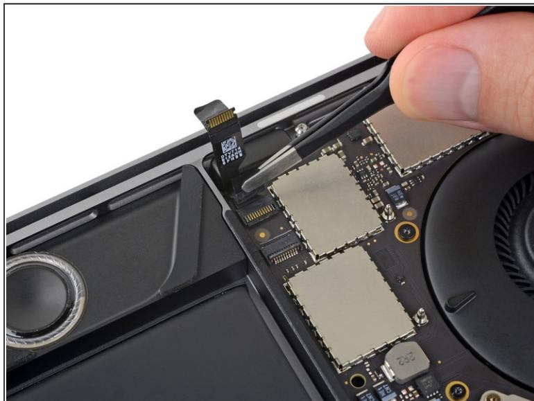
**i** 高音扬声器的柔性电缆下方是第二个ZIF接口，用于左主扬声器。
