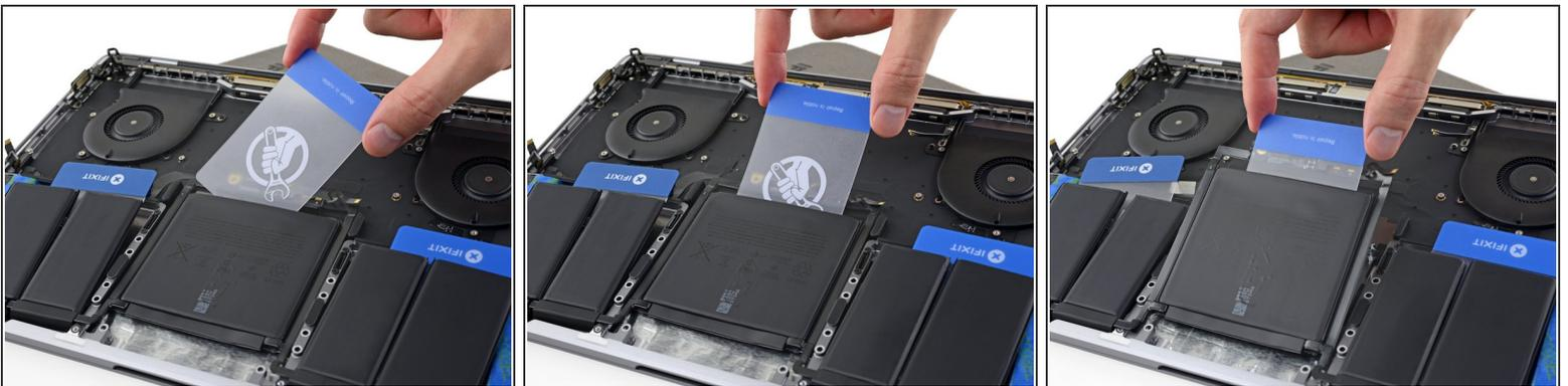
**i** 最终的电池单元可能更难以移除。如果需要，使用更多的粘合剂去除剂，使工作更容易。
