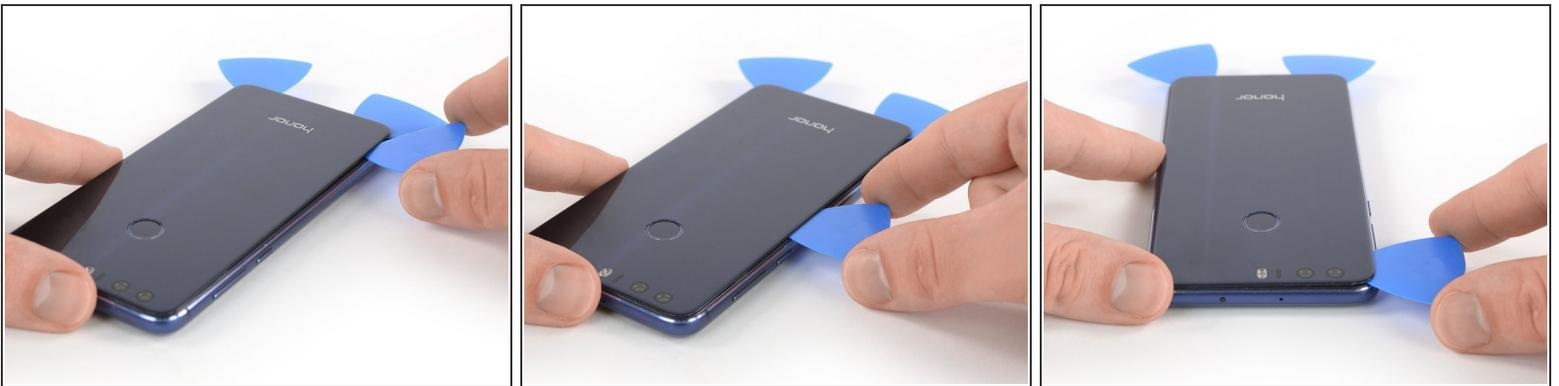
**⚠** 指纹电缆位于手机此侧的电源和音量按钮上方。仅在此区域使用开口撬的尖端，以免造成损坏。
