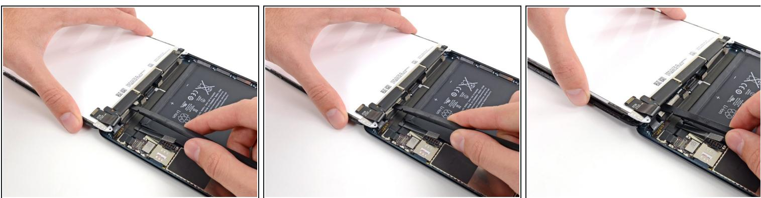
➤ LCD此时仍通过下方的两条宽胶带与后壳连接。
