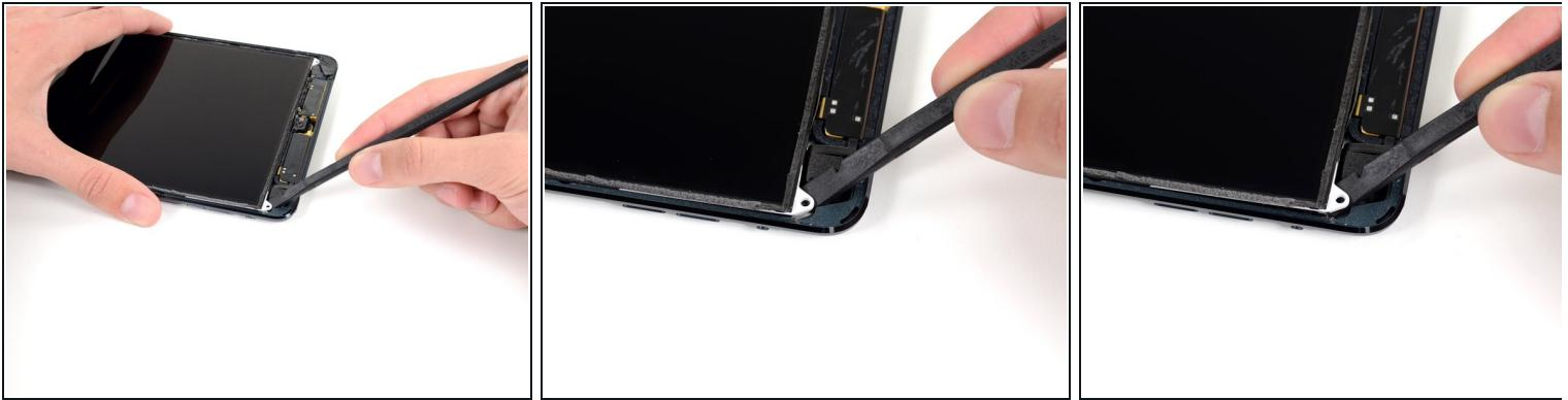
① 在接下来几步中，你将使用撬棒在LCD与金属背板之间滑动来将LCD从下方的粘合剂中分离出来。
