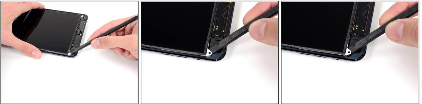
① 在接下来几步中，你将使用撬棒在LCD与金属背板之间滑动来将LCD从下方的粘合剂中分离出来。
