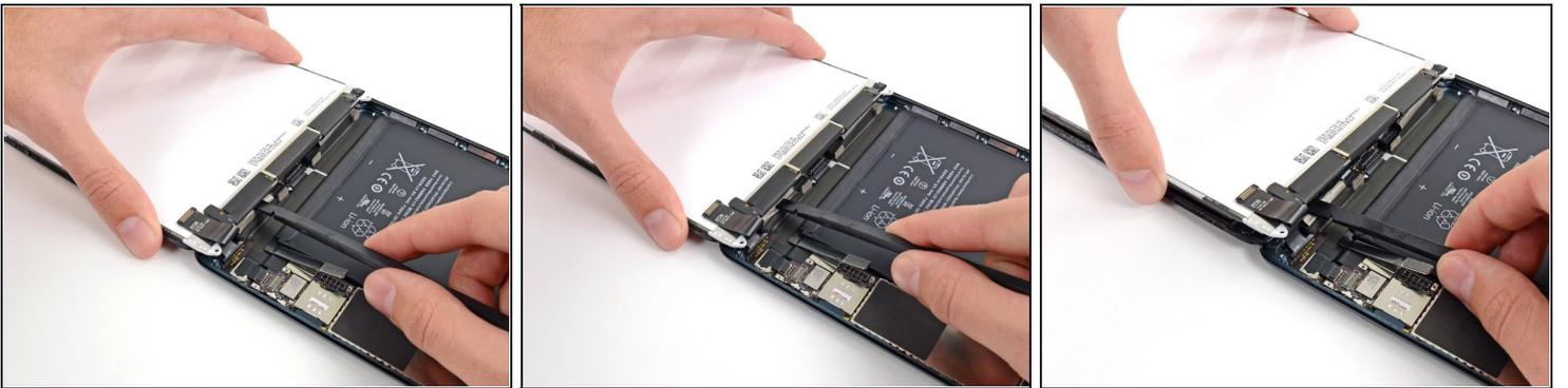
**✦** LCD此时仍通过下方的两条宽胶带与后壳连接。
