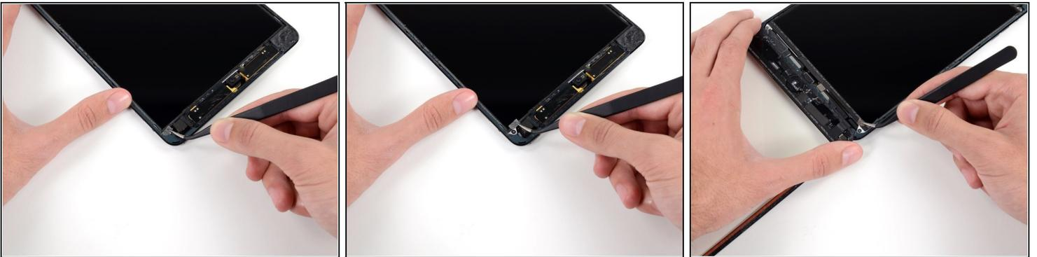
ⓘ 小的海绵胶带保护着顶部, 底部右手边有螺丝将LCD与后壳相固定。
