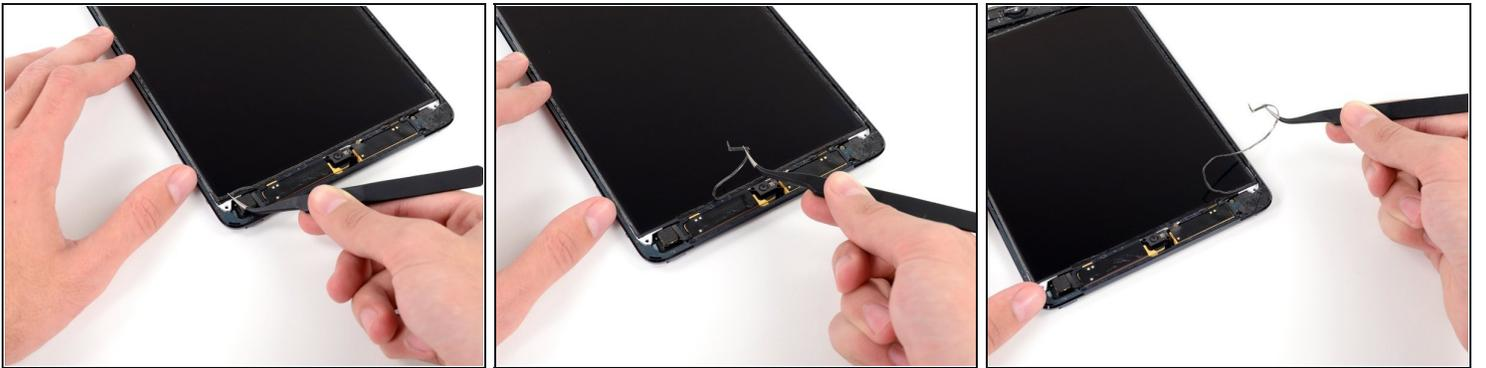
① LCD框架上贴着一一条薄薄的海绵胶带，将LCD面板下方的胶带相连接。要继续，你需要将其破坏然后剥离一些，暴露下方的胶带。
