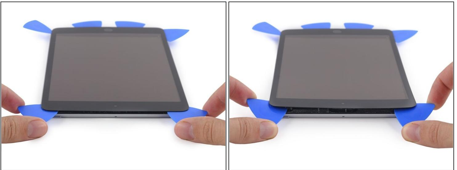
⚠ 小心操作这一步，花点时间保证粘合剂是热和软的，同时确保您的撬片已经分离开了该分离的粘合剂。不要怕返工和重新加热。
