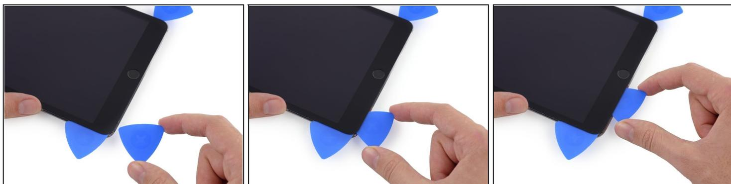
① 将原撬片放置在原位，以防粘合剂重新粘合。
