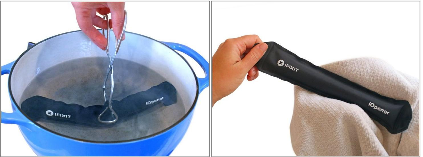
ⓘ 如果你没有微波炉，请按照此步骤在沸水中加热iOpener。
