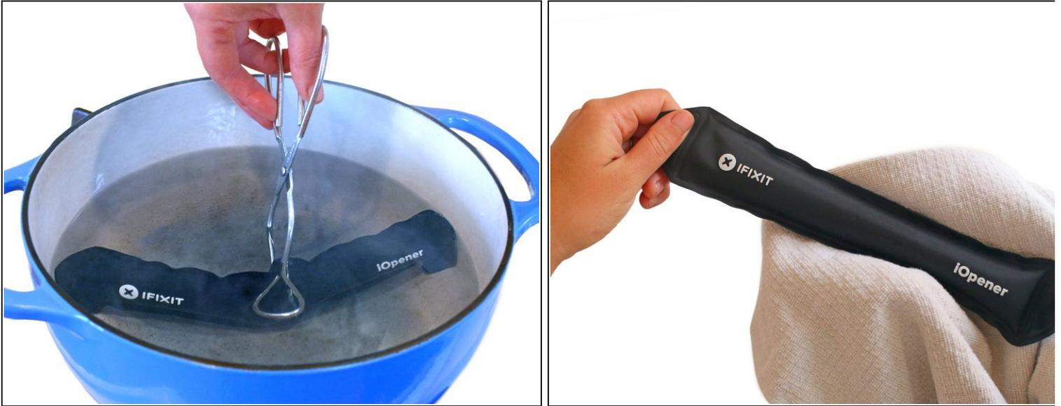
**i** 如果你没有微波炉，请按照此步骤在沸水中加热iOpener。
