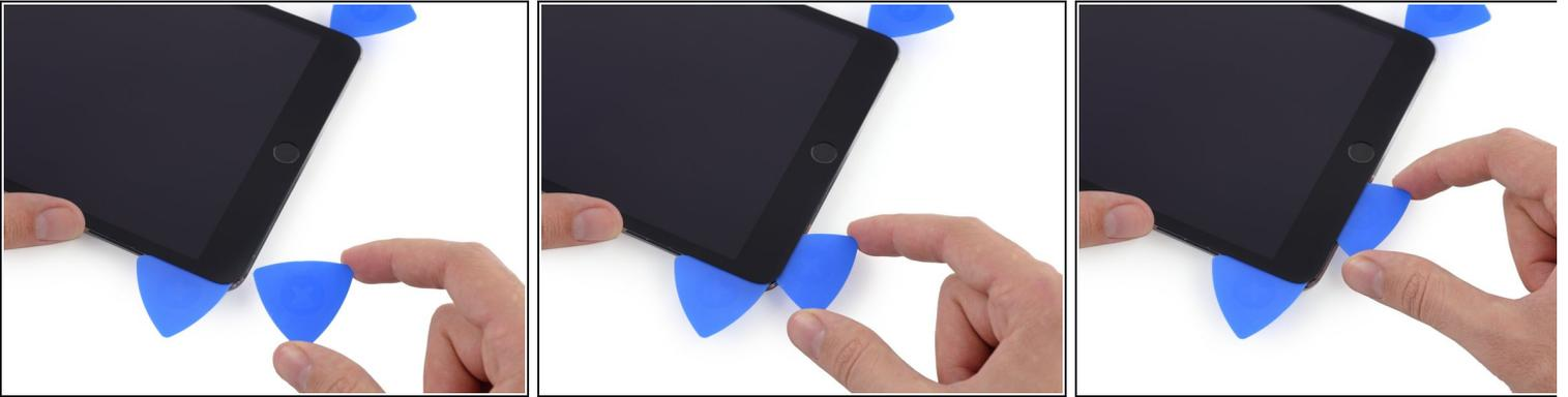
① 将原撬片放置在原位，以防粘合剂重新粘合。
