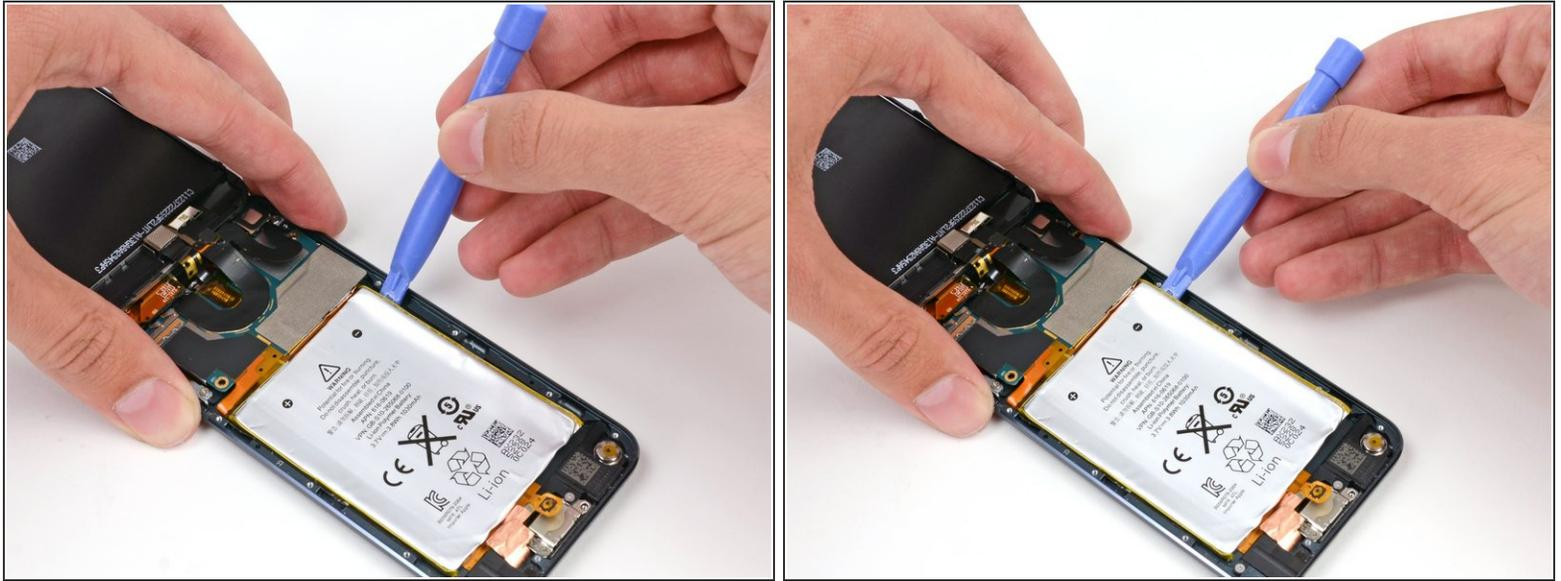
**i** 电池两侧有三个凹口。在接下来的几个步骤中，您将使用这些凹槽逐渐从后盖撬起电池。
