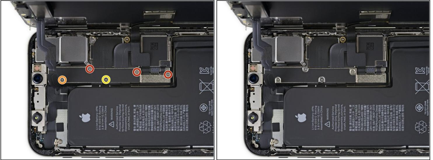
● 卸下固定主板连接器支架的五颗螺钉，如下所示：
