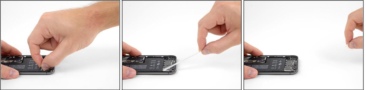
① 接下来，你应该缓慢拉动粘合胶带来展开位于电池下方的粘合剂，这是一种特殊的粘合剂，它会在受到拉伸时失去黏性，让你可以轻松地取出电池。
