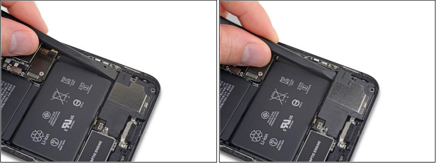
**⚠** 撬起扬声器时，请注意不要损坏刚刚断开的扬声器柔性电缆。如有必要，将电缆弯向电池，使扬声器有空间出来。
