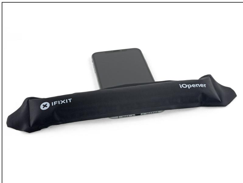
① 加热iPhone的下边缘有助于软化粘合剂，确保显示器更容易打开。
