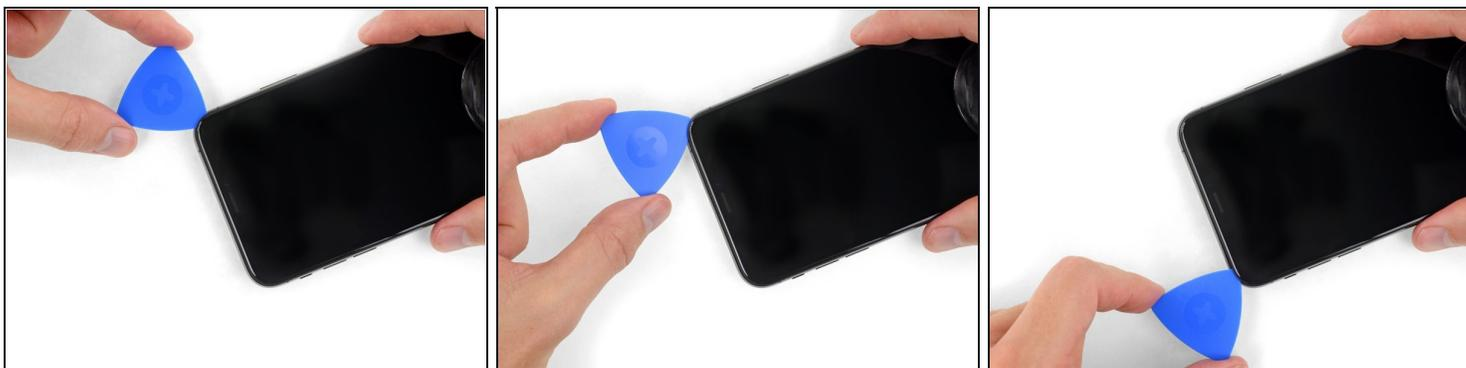
① 显示屏幕的上边缘用胶水和卡扣固定。
