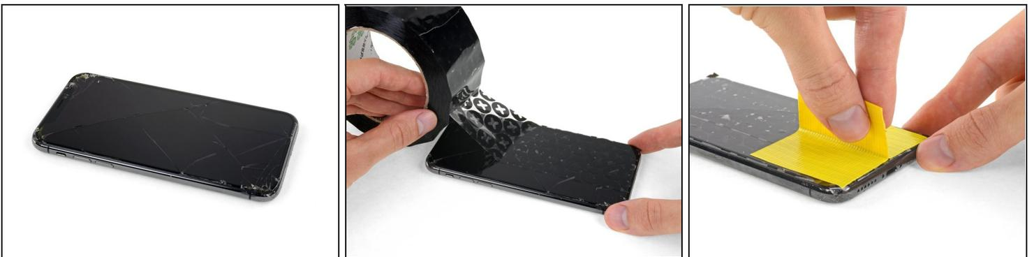
ⓘ 如果您的 iPhone 屏幕破裂，请在维修过程中用胶带粘住玻璃，以防进一步的破损和人身伤害。
