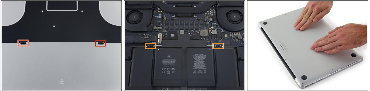
ⓘ 底部盖板上有两个塑料夹子（红色），在上面的箱子里卡扣（橙色）可以装进塑料夹子。
