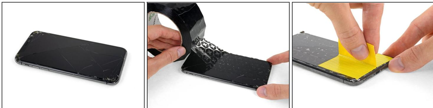
ⓘ 如果你的 iPhone 屏幕破裂，请在维修过程中用胶带粘住玻璃，以遏制进一步的破损并防止人身伤害。
