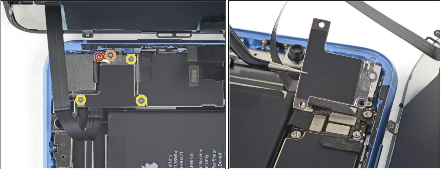
● 拧下将逻辑板连接器支架固定至后壳的五颗螺钉：
