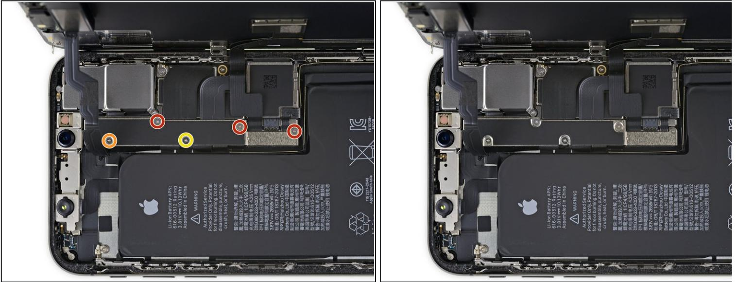
● 卸下固定主板连接器支架的五颗螺钉，如下所示：
