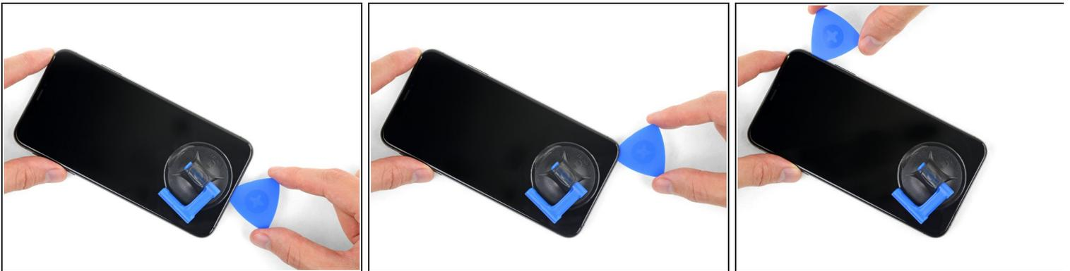
● 在 iPhone 的底部沿边缘插入您的拆机翘片，然后向右滑动，继续分离粘合胶。
