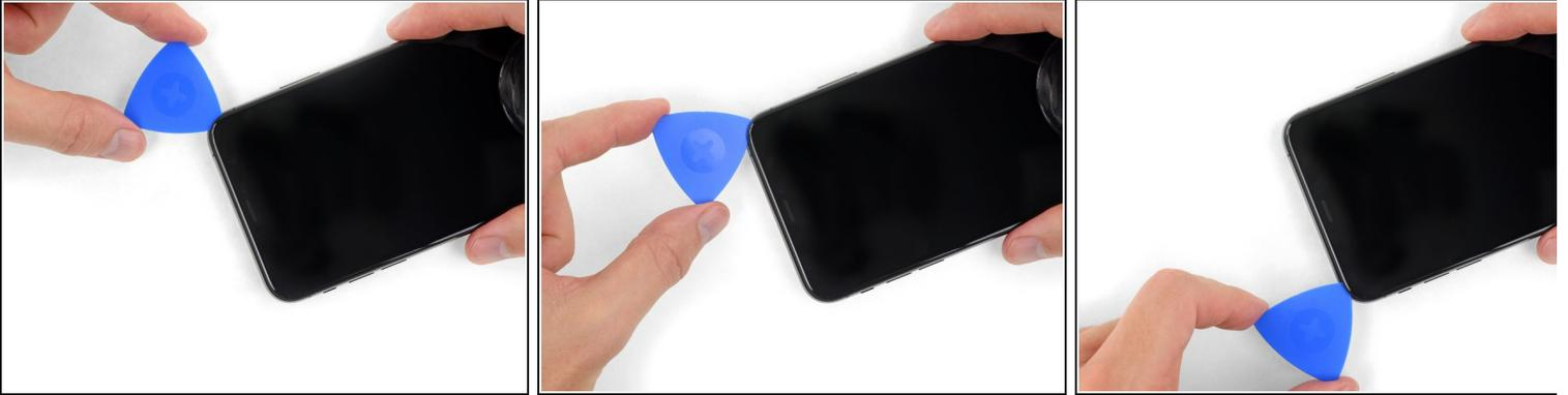
**i** 显示屏幕的上边缘用胶水和卡扣固定。
