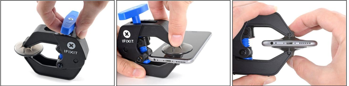
① 接下来的两个步骤演示了如何使用反向钳，一个旨在简化打开过程的工具。如果你不使用反向钳，请跳过这两个步骤以使用替代方法。
