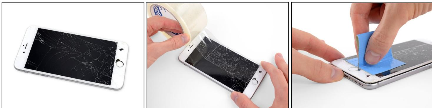
ⓘ 如果 iPhone 的后玻璃破裂，请在维修过程中通过在玻璃上贴胶带来防止进一步破损并防止人身伤害。
