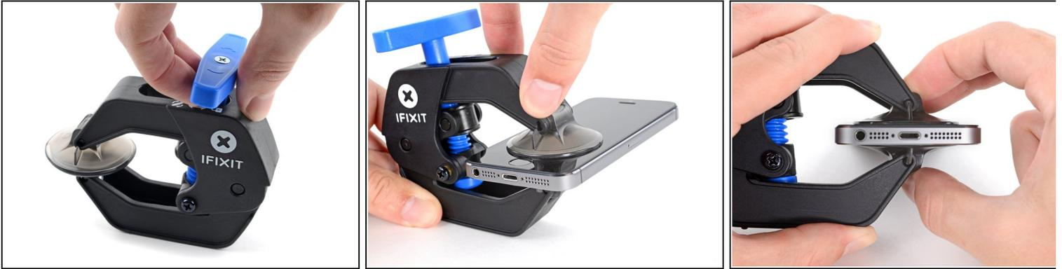
❗ 接下来的两个步骤演示了如何使用反向钳，一个旨在简化打开过程的工具。如果你不使用反向钳，请跳过这两个步骤以使用替代方法。
