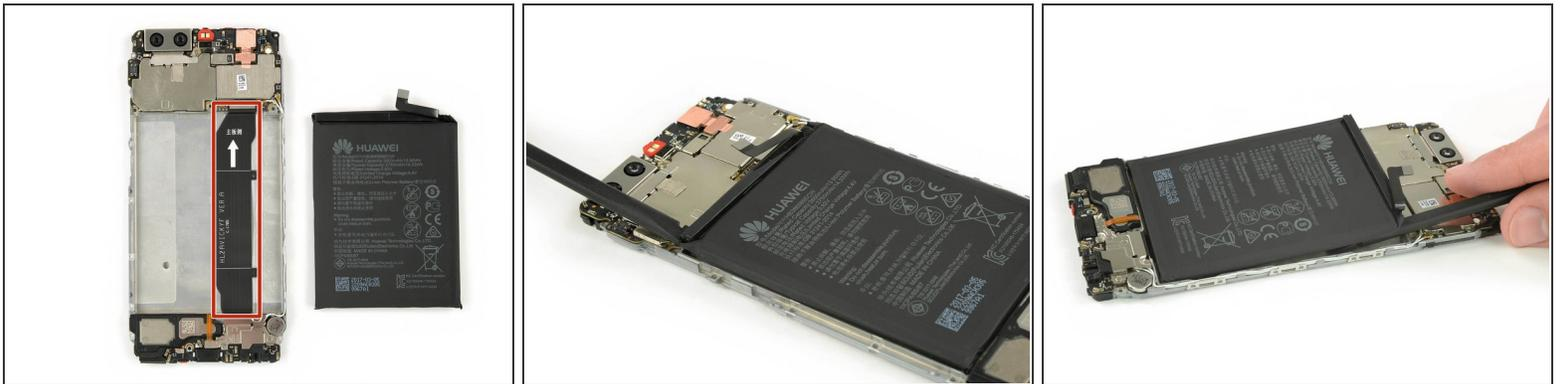
**⚠ 在以下步骤中，避免弯曲或刺破电池很重要，损坏可能导致电池起火。**
