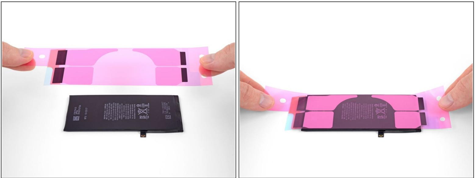
**i** 当胶条贴在电池上后，您就不能将其揭掉再重新定位了——所以如果您操作失误的话，您就必须更换新的胶条了。
